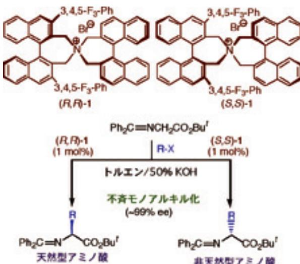
本法により、各種の生理活性アミノ酸が容易に合成できるばかりか、既存の工業的方法では入手しにくい各種の人工アミノ酸の大量合成が可能になった。また、先例のない不斉二重アルキル化反応の開発に
