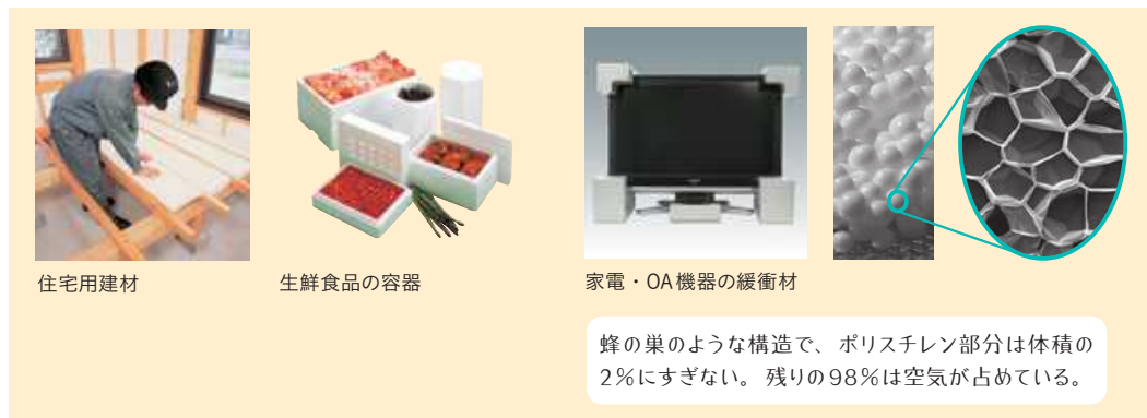
図2. 発泡スチロールの用途と拡大写真
